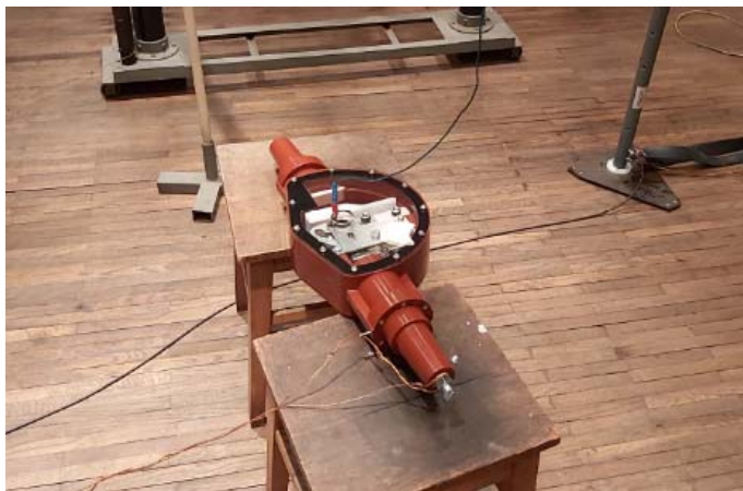
Slika 7. Laboratorijsko ispitivanje vakuumske komore udarnim naponom
